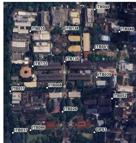
Gambar 8. Pesebaran titik-titik pengamatan survei statik GPS ( sumber : arsip pribadi )
